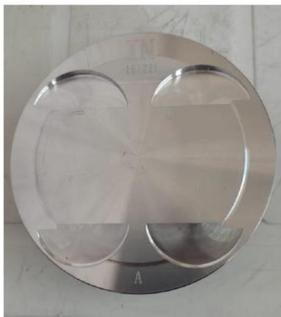
Se entiende por “conjunto de Pistón original” únicamente a los siguientes elementos: Pistón, Aros (3), Perno de Pistón, Seguros” (las marcas en el frente del Pistón son: Letra “A”, “IN”, y “NRO. DE PIEZA”). Ver imágenes.
