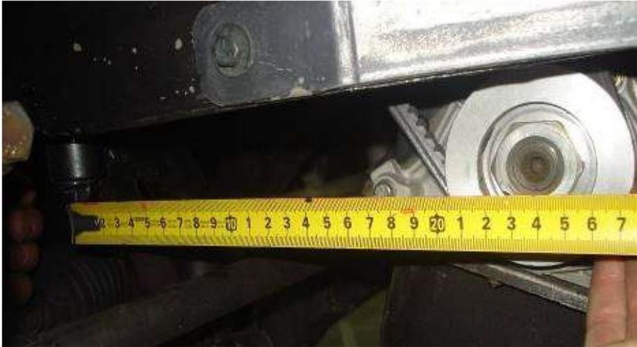
Se indica 70mm tomada desde el plano superior horizontal del falso chasis al centro del cigüeñal y perpendicular a éste. (+/- 5 mm)
