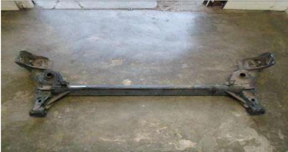
EN ANCLAJE CON CARROCERÍA SE PERMITE REEMPLAZAR BUJE POR OTRO DE DIFERENTE MATERIAL, CONSERVANDO SUS COTAS. **NO RÓTULA**
