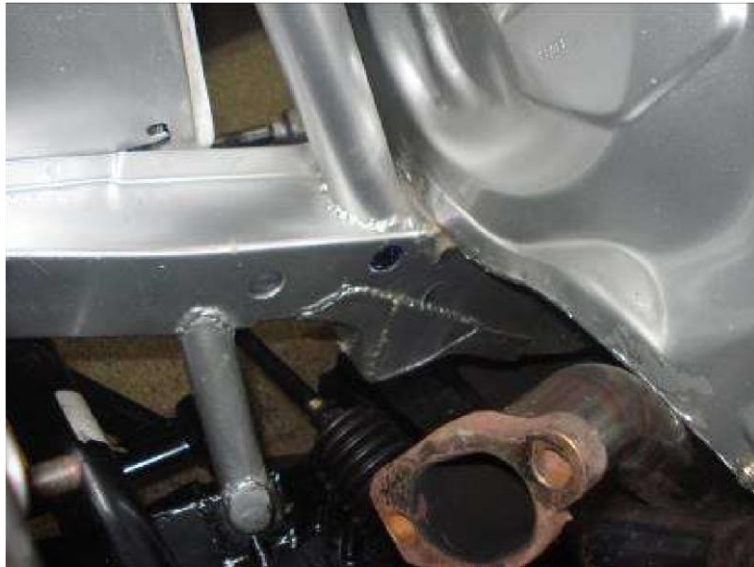
Orificio en larguero para referencia de posición de motor.
