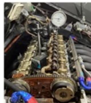
Medición alzada de válvulas
