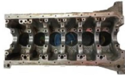
**Block motor Visto de abajo**
