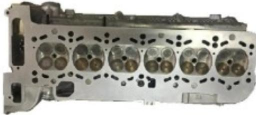
Tapa de cilindros Visto de abajo
