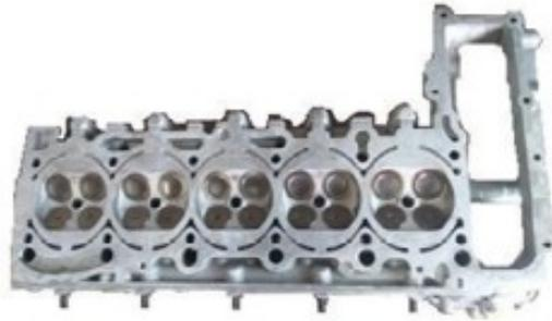
Tapa de cilindros Visto de abajo
