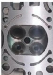
Tapa de cilindros Vista cámara de combustión
