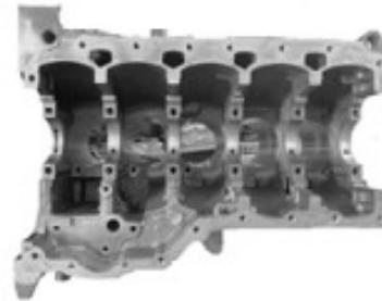
**Block motor** Visto de abajo
