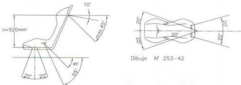
Debe instalarse un arnés de seguridad en los puntos de anclaje del automóvil de producción en serie hacia abajo, las tiras del hombro deben orientarse hacia la parte trasera y deben instalarse de forma tal que no formen un ángulo de más de 45° respecto de la horizontal desde el borde superior del respaldo, si bien se recomienda que este ángulo no exceda los 10°.
