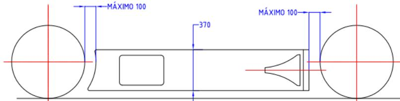
El largo del pontón se deberá adaptar de acuerdo al entre ejes del automóvil, respetando la separación máxima acotada respecto de los neumáticos.
