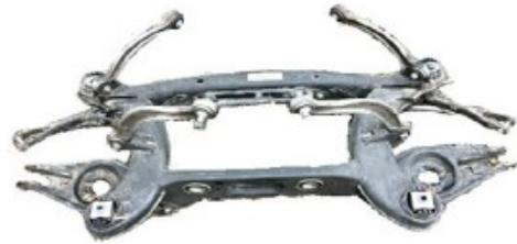
Suspensión trasera completa desmontada
