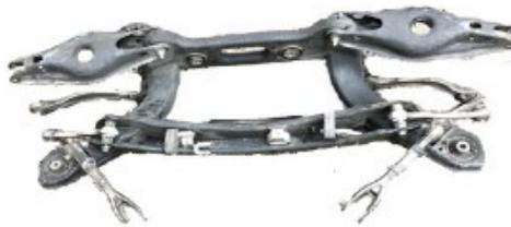
Suspensión delantera completa desmontada
