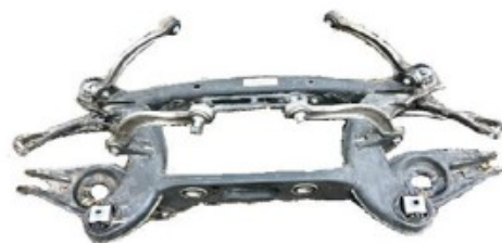
Suspensión trasera completa desmontada
