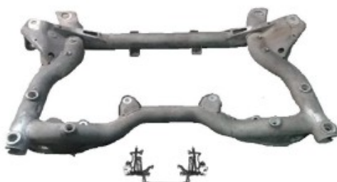
Subchasis delantero, visto de arriba
