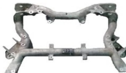
Subchasis delantero, visto de abajo
