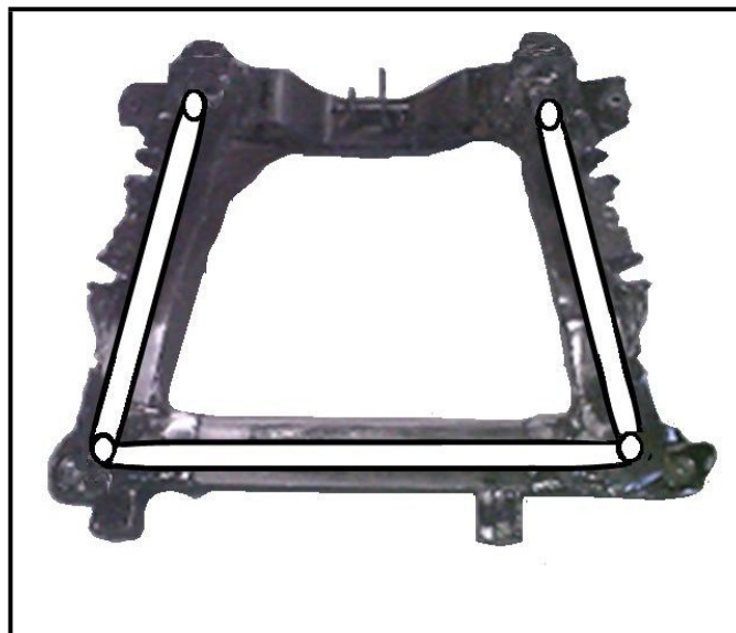
Bastidor. con caño refuerzo 38 mm interno
