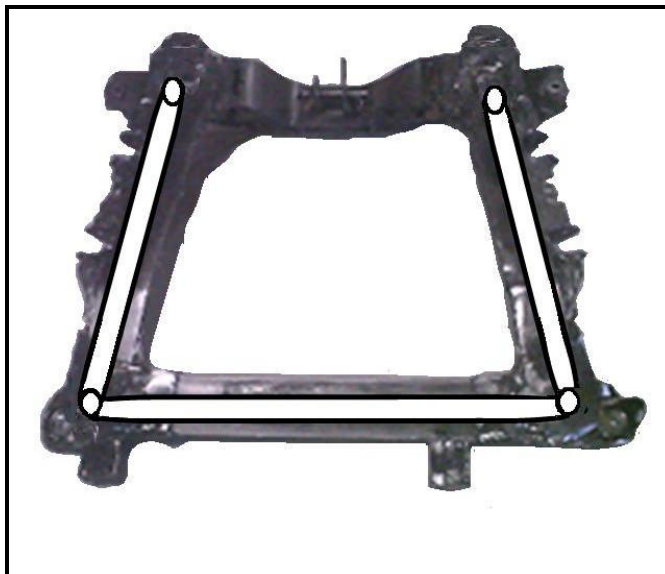
Bastidor. con caño refuerzo 38 mm interno
